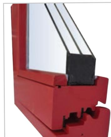
Épaisseur de l'ouvrant et du dormant de 88 mm et triple vitrage 4/18/4/18/4 FE + gaz argon une isolation thermique et acoustique optimales.
